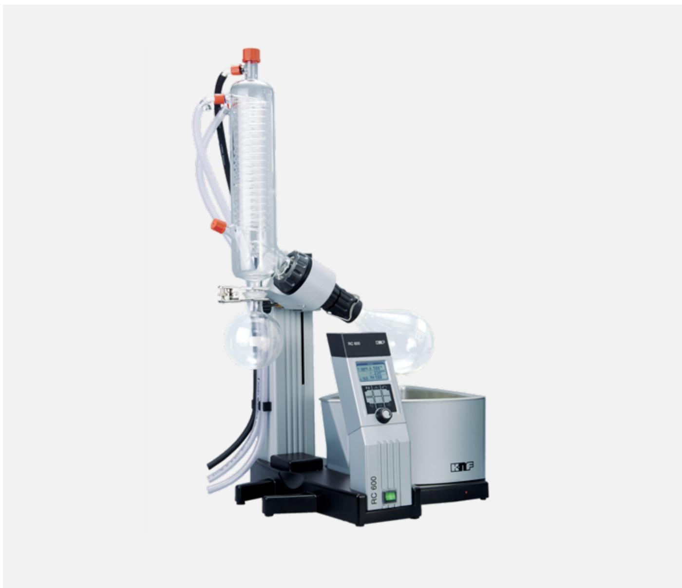
Ротационный испаритель RC600 обладает простым и интуитивным интерфейсом, а также высокой компактностью. Электрический подъемник делает работу простой и безопасной. К преимуществам RC600 относятся также быстрая и безопасная замена испарительной колбы, беспроводная нагревательная баня и возможность выбора между конденсатором и охлаждаемой ловушкой на сухом льду.
