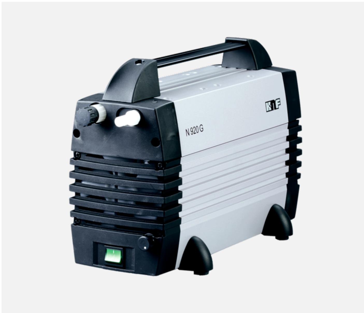
Химстойкий, безмасляный мембранный насос со встроенным регулятором скорости вращения вала двигателя для настройки требуемой производительности. Оснащен встроенным газобалластом, рабочей головкой из PPS, мембранами с PTFE покрытием и клапанами из FFPM.
