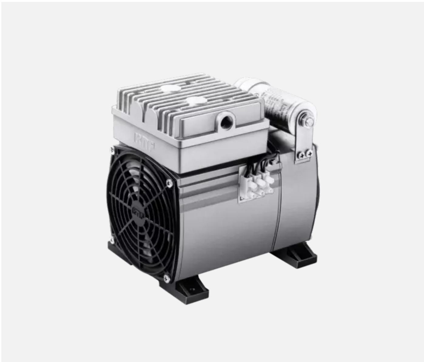
Газовые насосы KNF с качающимся поршнем подходят для сжатия, транспортировки и откачивания. Они работают на 100% без масла, в любом положении и поставляются во многих различных вариантах двигателя. Насосы с качающимся поршнем – это компактное устройство для создания давления и вакуума. Они имеют более высокую производительность, чем аналогичные по габаритам мембранные насосы.
