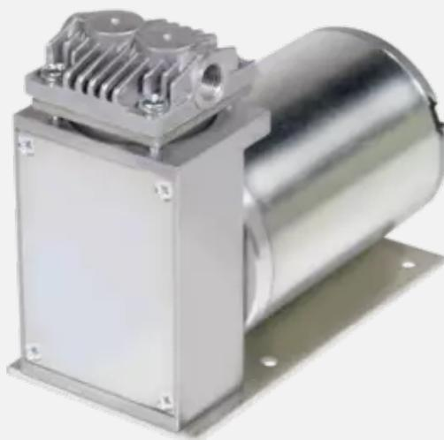
Газовые насосы KNF с качающимся поршнем подходят для сжатия, транспортировки и откачивания. Они работают на 100% без масла, в любом положении и поставляются во многих различных вариантах двигателя. Насосы с качающимся поршнем – это компактное устройство для создания давления и вакуума. Они имеют более высокую производительность, чем аналогичные по габаритам мембранные насосы.
