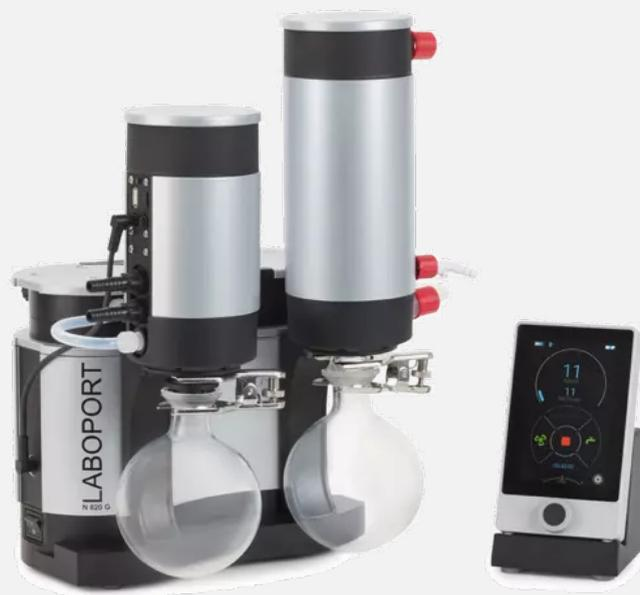
Химостойкая откачная система, состоящая из химически стойкого мембранного вакуумного насоса, основания, сепаратора на входе, высокопроизводительного конденсатора на выходе и вакуумного контроллера. Оптимально подходит для ротационного испарения и применения в других технологиях, требующих контроля уровня вакуума.
