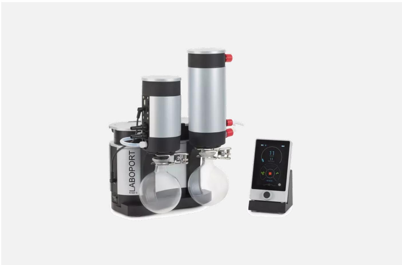
Химостойкая откачная система, состоящая из химически стойкого мембранного вакуумного насоса, основания, сепаратора на входе, высокопроизводительного конденсатора на выходе и вакуумного контроллера. Оптимально подходит для ротационного испарения и применения в других технологиях, требующих контроля уровня вакуума.
