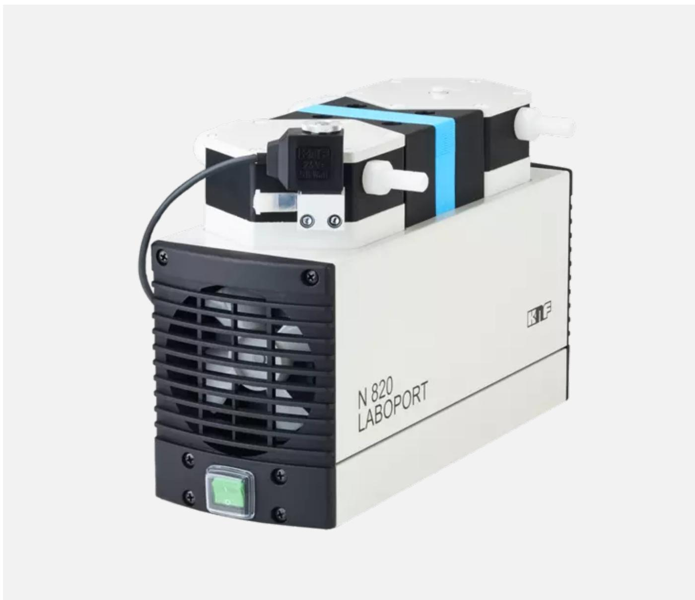
Химстойкий мембранный насос с рабочей головкой из PTFE, мембраной с покрытием из PTFE и клапанами из FFPM. Встроенная система самоосушки препятствует накоплению конденсата внутри головки. Идеален для откачки агрессивных и влагосодержащих сред.
