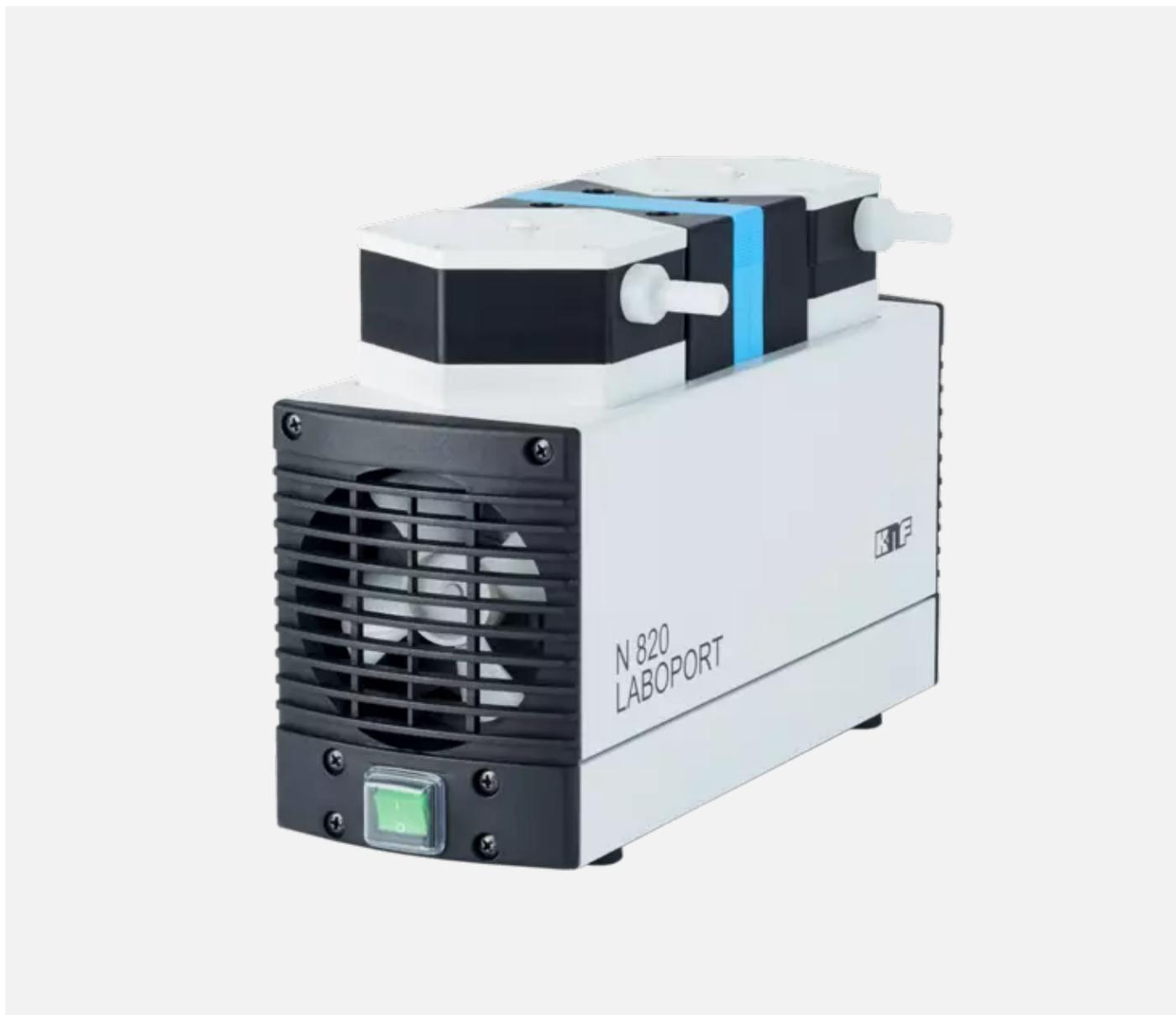
Химстойкий, компактный, безмасляный мембранный вакуумный насос с ручной регулировкой скорости для настройки производительности насоса в соответствии с вашими задачами. Оснащен головками из PTFE/TFM, мембраной с покрытием PTFE и клапанами из FPM. Подходит для широкого спектра лабораторных задач, включая работу с высоко агрессивными/коррозийными газами и парами.
