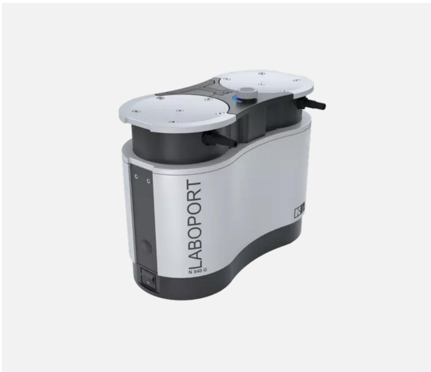
Химстойкий, компактный, безмасляный мембранный вакуумный насос с ручной регулировкой скорости для настройки производительности насоса в соответствии с вашими задачами. Оснащен газобалластным клапаном, головками из PTFE/TFM, мембраной с покрытием PTFE и клапанами из FPM. Подходит для широкого спектра лабораторных задач, включая работу с высоко агрессивными/коррозийными газами и парами.
