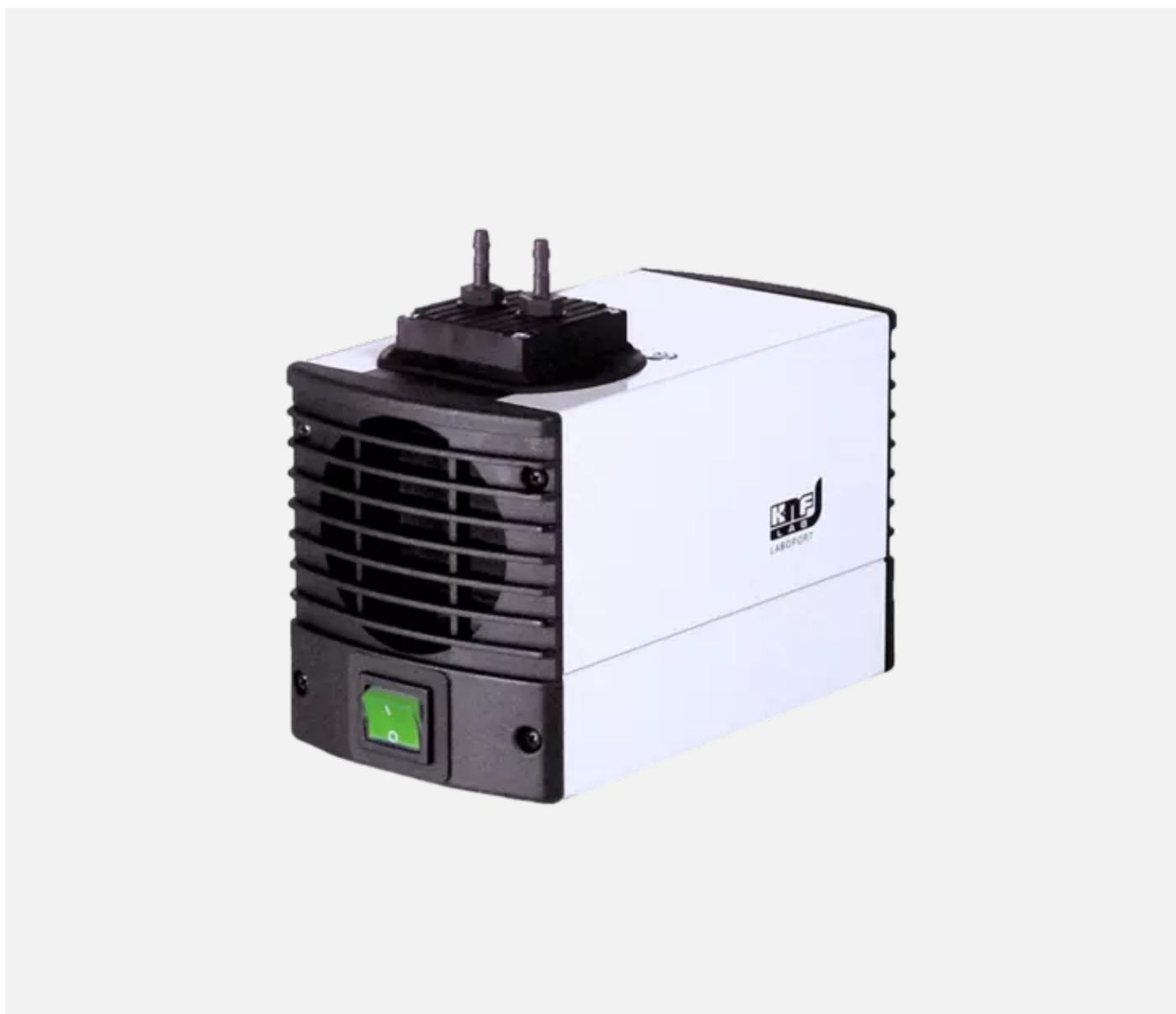
Химстойкий, безмасляный мембранный вакуумный насос, применимый для широкого ряда лабораторных технологий. Насос оснащен головками из PPS, мембанами из PTFE и клапанами из FFPM.
