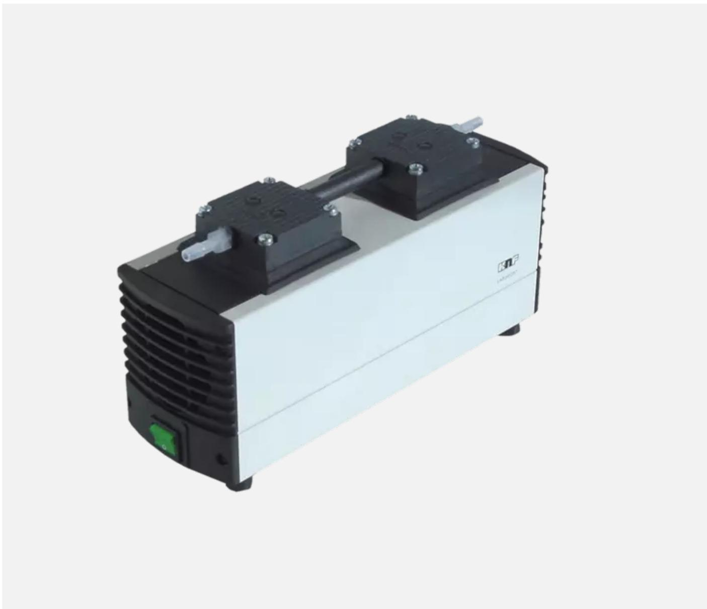
Химстойкий, безмасляный мембранный вакуумный насос, используемый для широкого ряда лабораторных применений. Оснащен головкой из PPS, мембранами с PTFE покрытием и клапанами из FFPM
