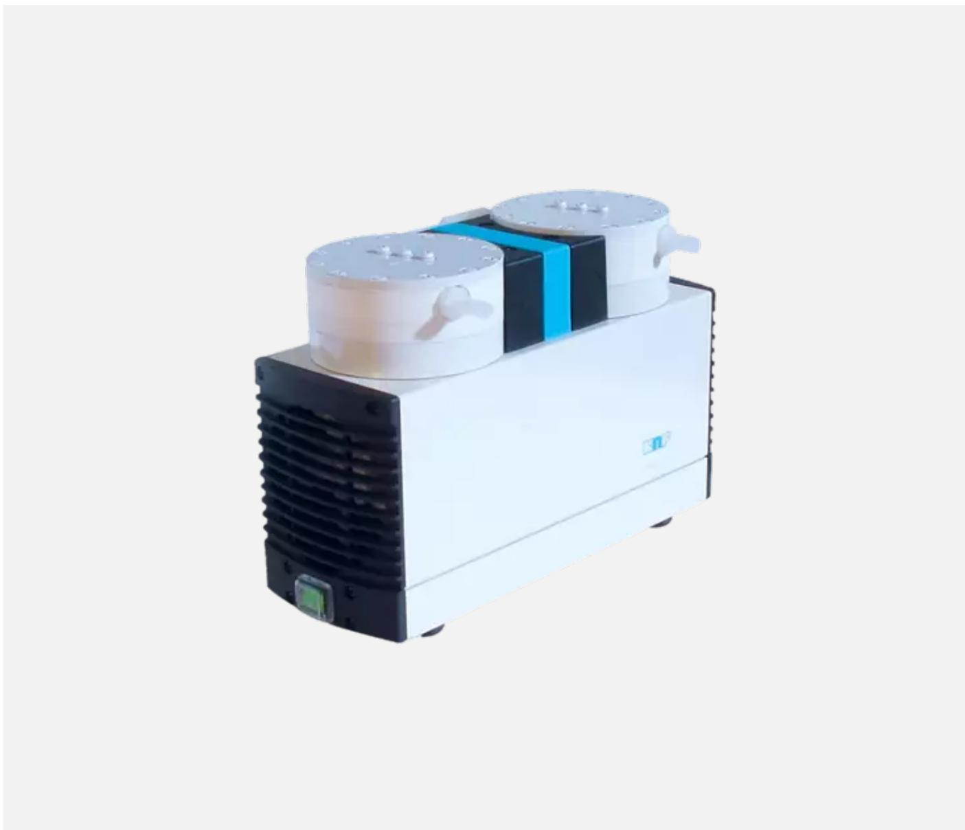
Химстойкий, безмасляный мембранный вакуумный насос, применимый для широкого ряда лабораторных технологий. Наиболее эффективен для перекачки агрессивных газов и паров, поскольку оснащен головками из PTFE, мембранами с PTFE покрытием и клапанами из FFPM.
