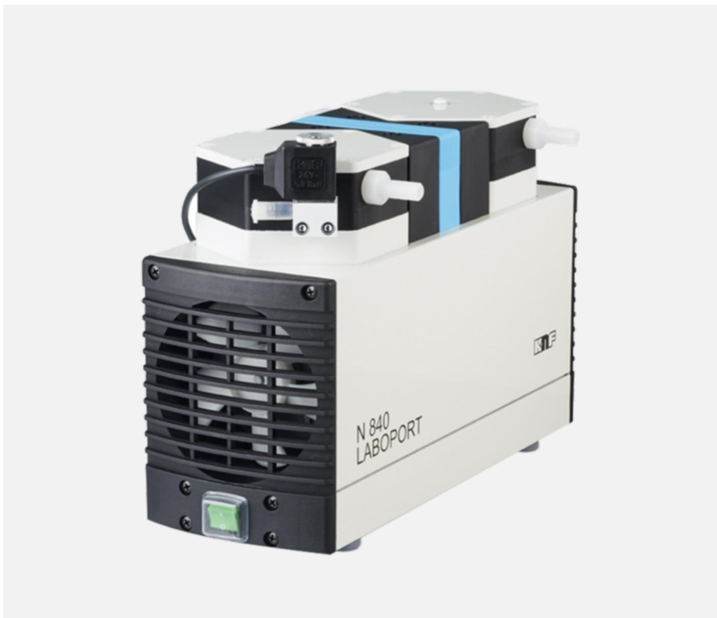
Химстойкий мембранный насос с рабочей головкой из PTFE, мембраной с покрытием из PTFE и клапанами из FFPM. Встроенная система самоосушки препятствует накоплению конденсата внутри головки. Идеален для откачки агрессивных и влажосодержащих сред.
