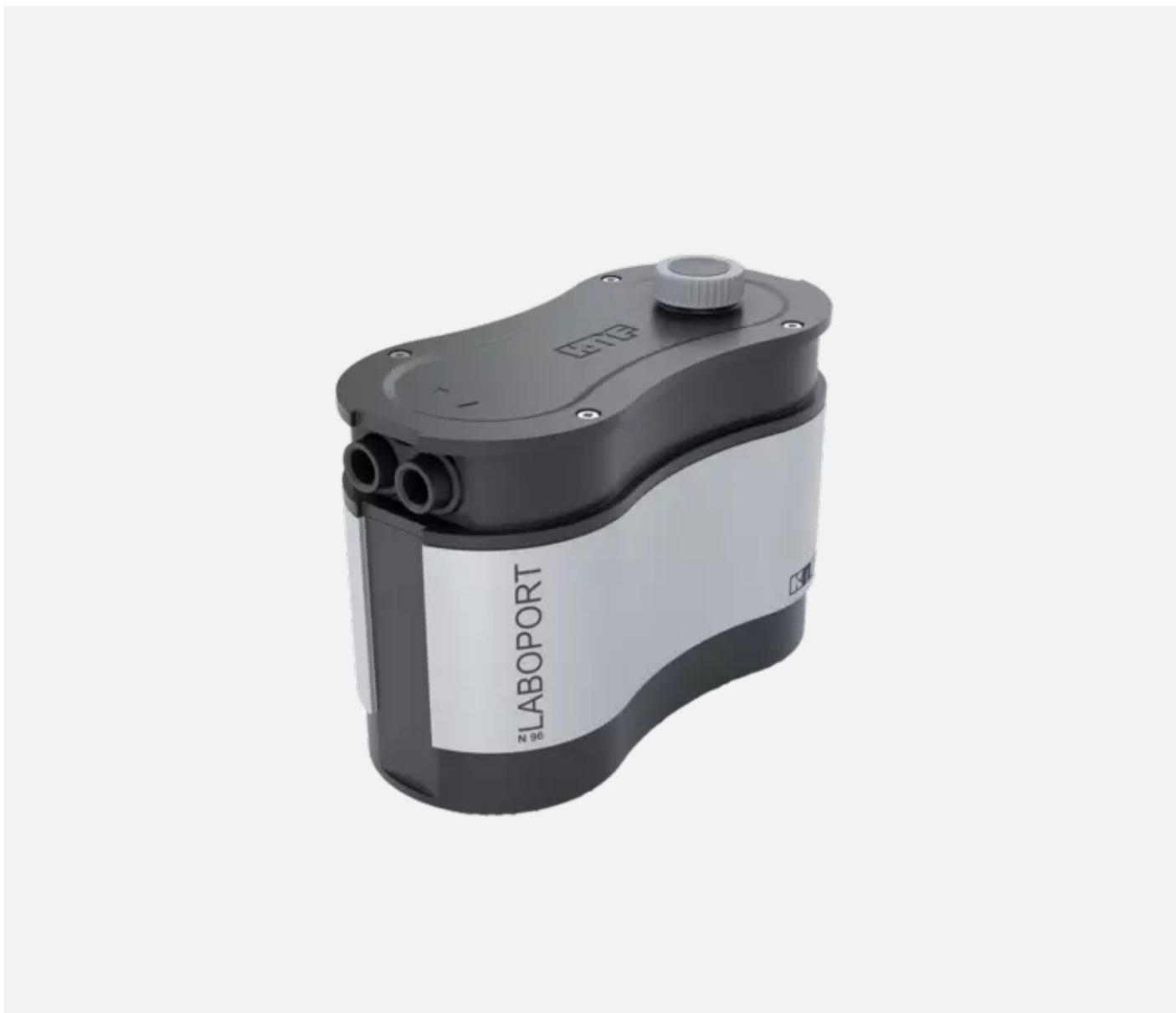
Очень компактный, химстойкий, безмасляный мембранный вакуумный насос с ручной регулировкой скорости для настройки производительности насоса в соответствии с вашими задачами. Насос оснащен головкой из PPS, мембраной с PTFE покрытием и клапанами из FKM. Подходит для широкого спектра лабораторных задач.
