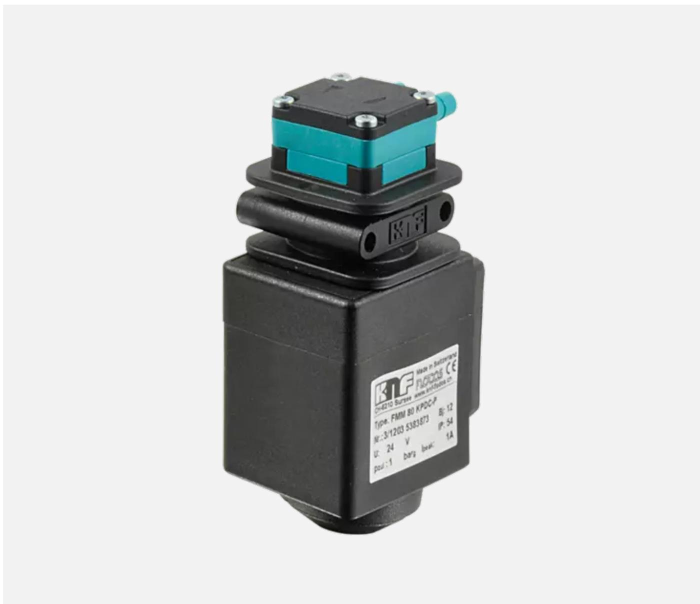
Мембранные жидкостные насосы KNF перекачивают нейтральные и агрессивные жидкости не загрязняя их. Они не требуют техобслуживания, самовсасывающие, могут работать "всухую". KNF предлагает широкий выбор двигателей разного типа и различные варианты управления.
